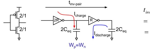
$t_{inv-pair} = t_{fall} + t_{rise}$  $= R2C_{eq} + 2R2C_{eq}$  $= 6RC_{eq}$
